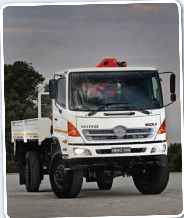
▲ Die Hino 1322 4x4-model in die 500-reeks het nou enkelagterwiele en 'n spoedbeperker.
